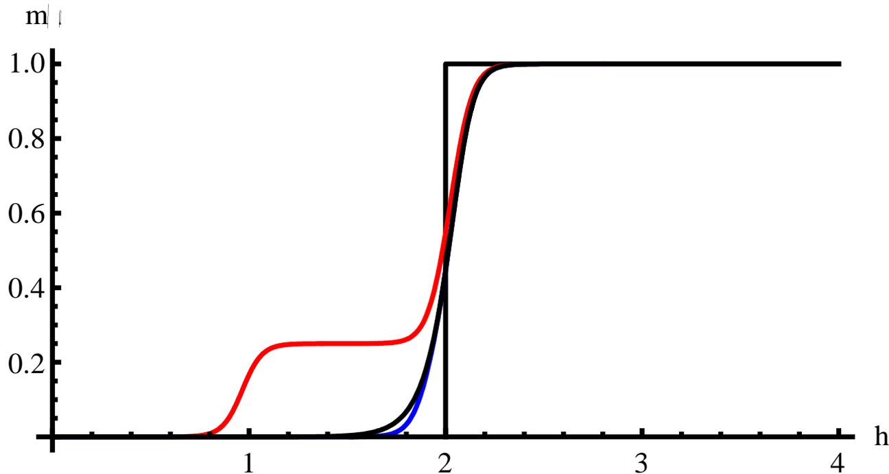
«Открытой» цепочке – отвечает красная линия, замкнутой цепочке – синяя линия, бесконечной цепочке – черная линия. При  $T = 0$  наблюдается квантовый фазовый переход первого рода – скачок намагниченности при  $\mu H=2|J|$
