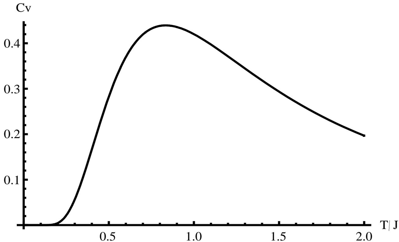
Температурная зависимость теплоемкости двухуровневой системы. Аномалия Шоттки.
