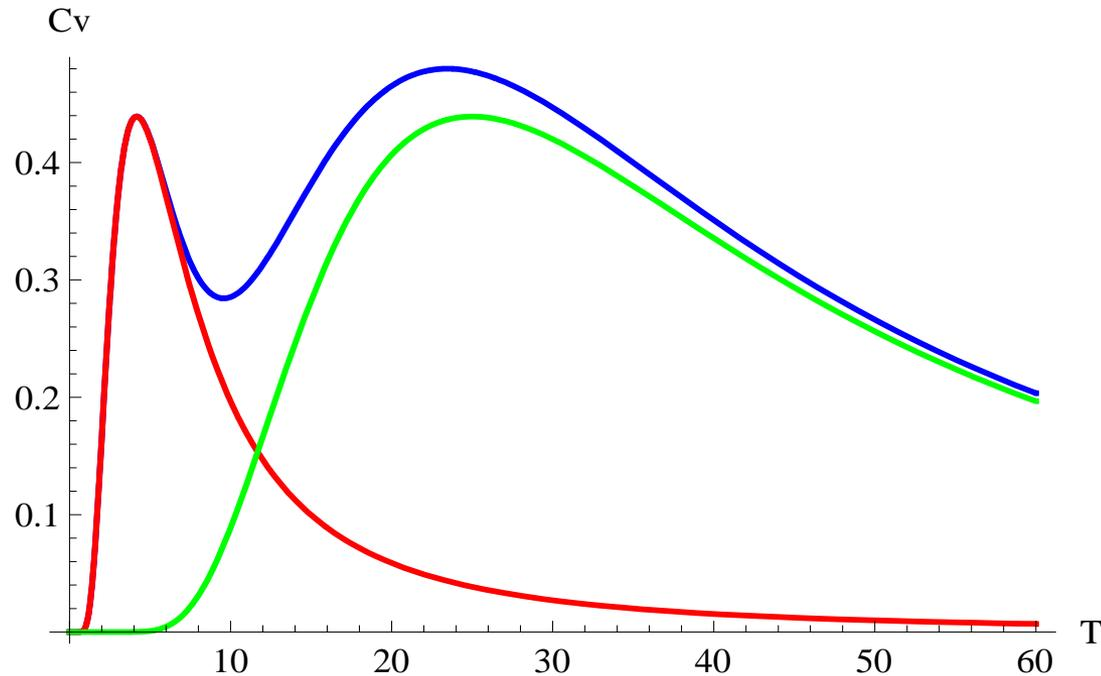
Из рисунка видно, что два максимума для цепочки с чередующимися взаимодействиями непосредственно связаны с аномалией Шоттки. Таким образом, в случае двух подрешеток (чередования взаимодействий) может быть две аномалии Шоттки в температурной зависимости теплоемкости в нулевом поле. Если же магнитное поле отлично от нуля, может появиться и третий максимум.
